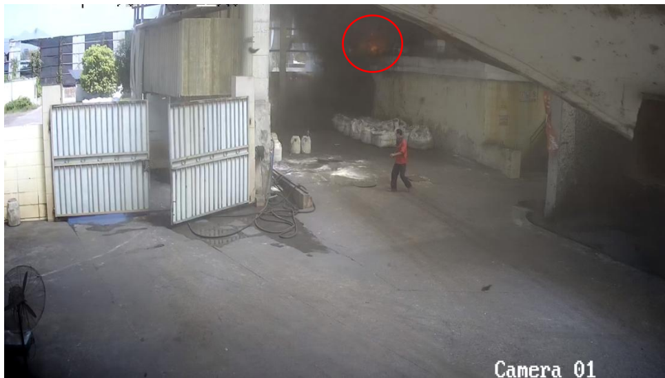
(图4 视频截图作业人员抽烟引起氢气燃爆事故的照片)
